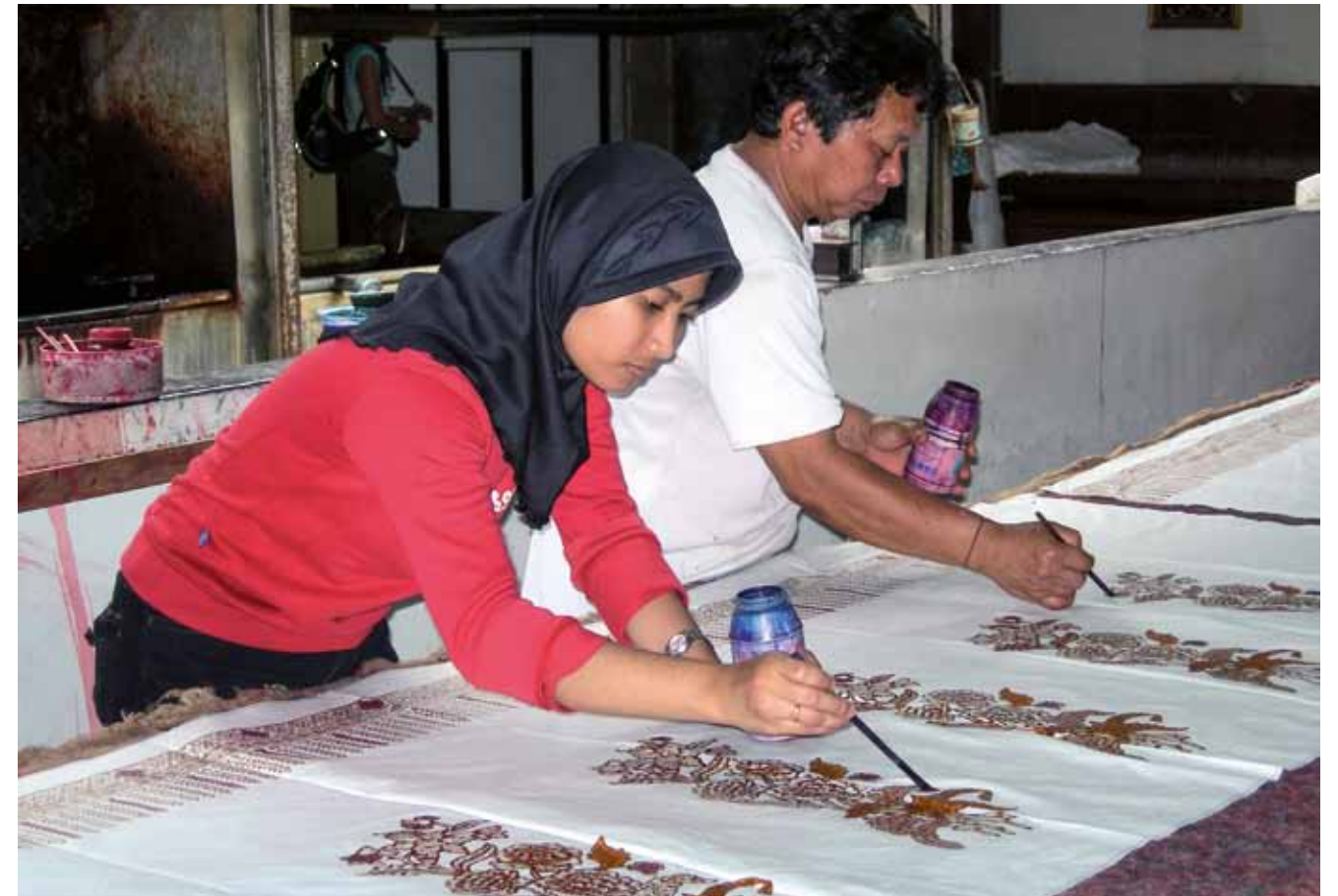
Дополнение восковой резервации росписью кистью (техника чолет ). Ява, г. Джокьякарта, мастерская «Батик Плентонг», 2009 г.
