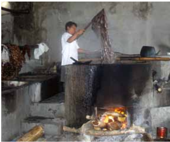
Процесс смывания воска с ткани в кипящей воде. Ява, г. Джокьякарта, мастерская «Батик Плентонг», 2009 г.
