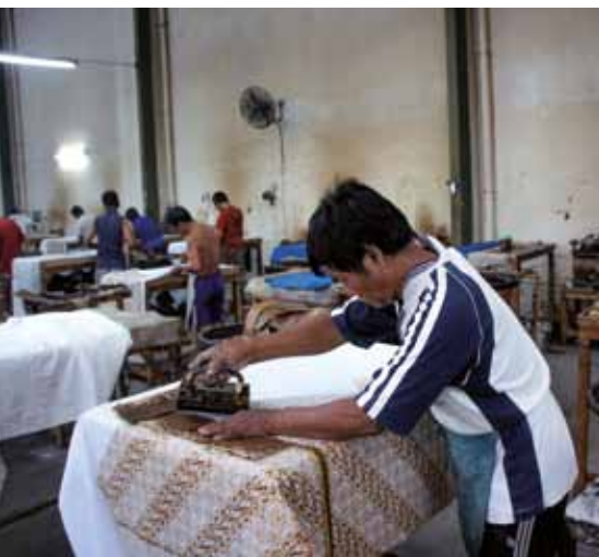
Нанесение воскового резерва штампом чапом . Ява, г. Суракарта, фабрика «Данар Хади», 2013 г.
