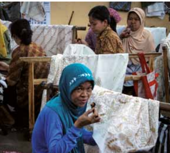
Нанесение воскового резерва на ткань. Ява, г. Суракарта, фабрика «Данар Хади», 2013 г.
